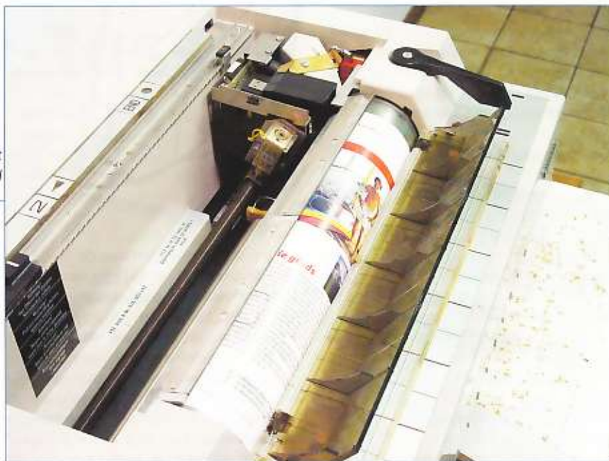
Een Hell faxmachine die nog gebruikt maakt van de draaiende trommel
